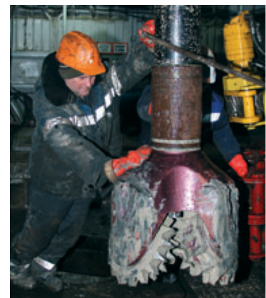
Извлечение долота из скважины на кусте № 55.
